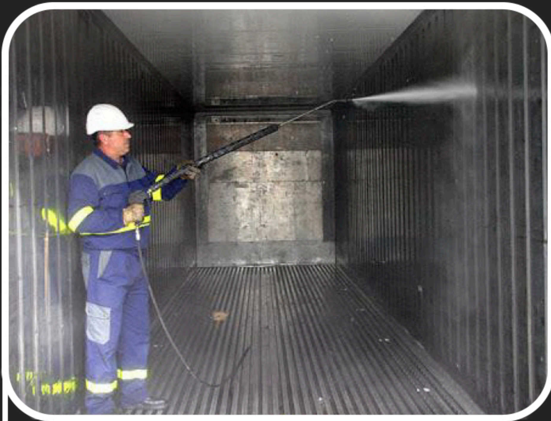
Lavado y desinfectado de contenedores
